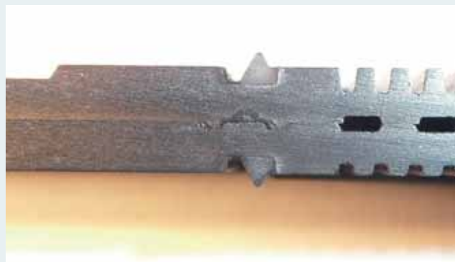
Schnitt durch gefügtes Kühlmodul Microsection of cooling unit
