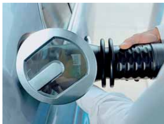
Betankung eines Wagens mit flüssigem Wasserstoff Refuelling of a car with liquid hydrogen
