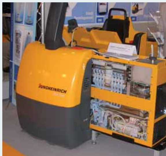
Projekt Horizontal-Kommissionierer (FZ Jülich) Fuel cell powered fork lift (FZ Jülich)
