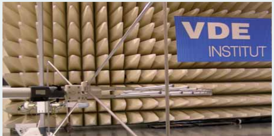
VDE-Labor zur EMV-Messung für Brennstoffzellen VDE laboratory for EMC measurement for fuel cells
