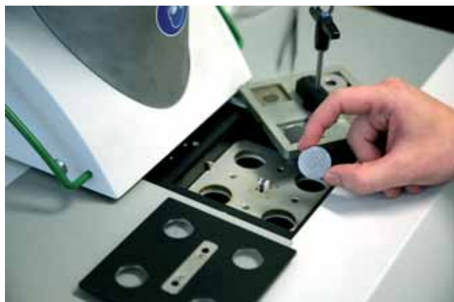
Ermittlung der Temperaturleitfähigkeit hochgraphitgefüllter Thermoplaste Thermal diffusivity of graphite containing thermoplastics
