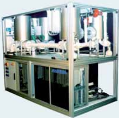
FC Maxi-Prüfstand für Nieder- und Hochtemperaturbrennstoffzellen FC Maxi-test bench for low and high temperature fuel cells
