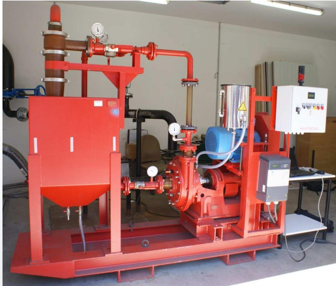
Prinzipieller Aufbau einer Versuchspumpe mit angebauter HAWITRONIC®
