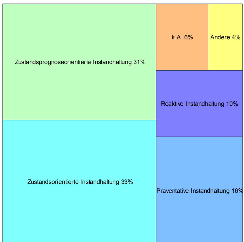
Abbildung 2: Bedeutung unterschiedlicher Instandhaltungsstrategien, die Fläche der einzelnen Felder entspricht dem Prozentualen Anteil aller Antworten.
