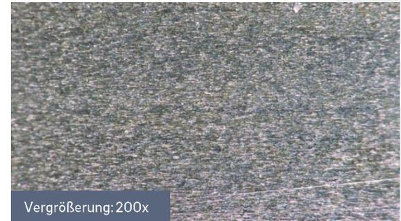
Mikroskopie Wälzlagerkörper, Castrol X320 **mit** REWITEC®
