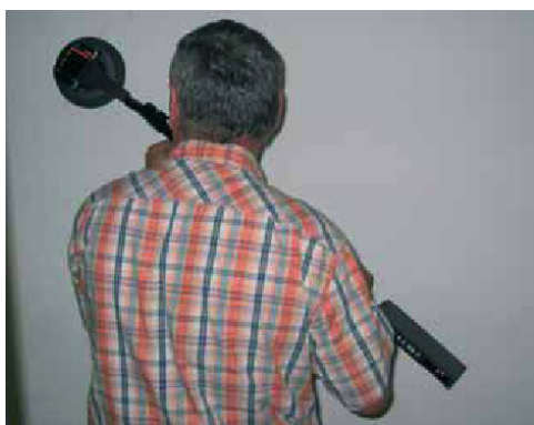
Links: Untersuchung einer Wand mit dem Nichtlinearitäten-Detektor. Das Gerät reagiert auf Unregelmäßigkeiten bei elektrischen Schwingungen.
